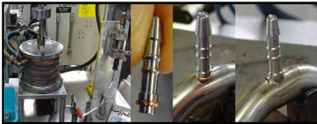
Rycina 7. Proces lutowania i wiercenia otworów
